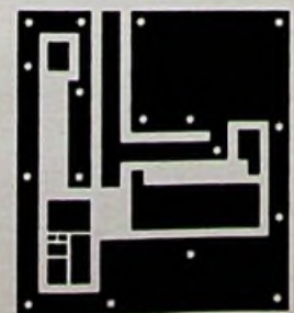
Afb. 7 Print van de microgolfoscillator van Steve Birkill, dubbelzijdig epoxy, schaal 1 : 1. Dit is de bovenkant, de onderkant is egaal koper.
